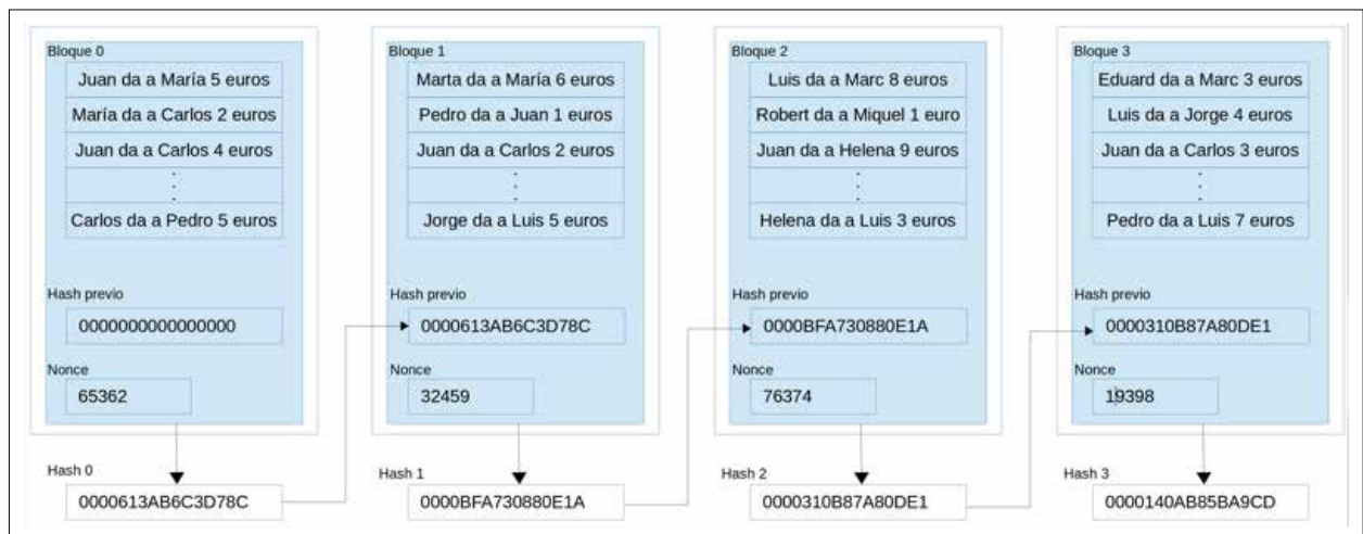
Figura 4: Encadenamiento de bloques a través de los hash calculados para cada bloque.
